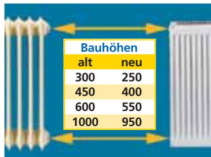
Die Nabenabstände der Modernisierungs-Heizkörper sind identisch mit den Nabenabständen der DIN-Radiatoren
