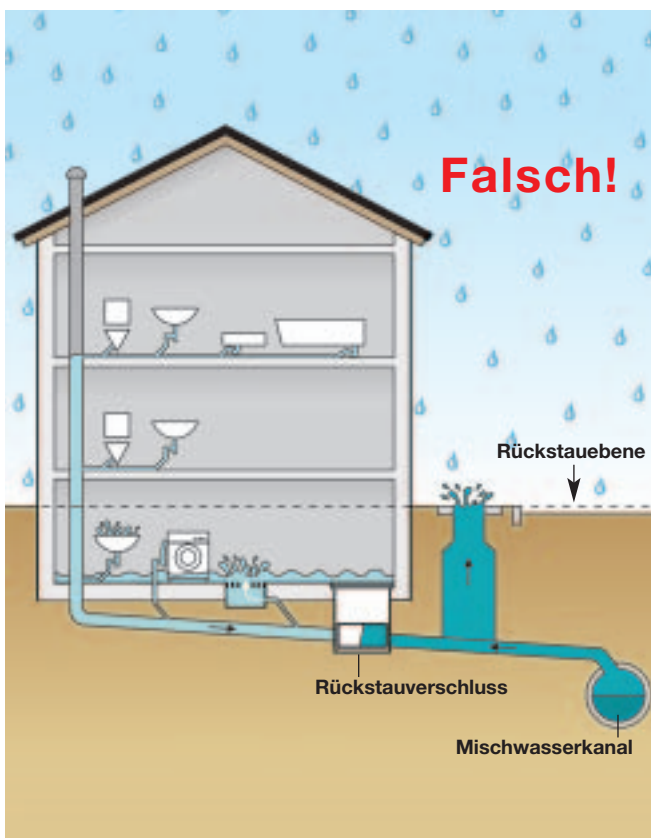
Werden oberhalb der Rückstauenebene Entwässerungsobjekte über einen Rückstauverschluss entwässert, kommt es bei Rückstau zu Überflutungen der unterhalb der Rückstauenebene liegenden Wohnräume
