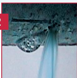
**Leitungsrückstände im Wasser sind verantwortlich für Korrosion und gefährlichen Lochfraß.** Der SYR PROTECT ist ein innovativer Rückspülfilter der neuesten Generation, der selbst winzige Rostpartikel, Metallspäne und Ablagerungen aus dem Rohrnnetz herausfiltert – ein Filter ist nach DIN 1988 Pflicht.
