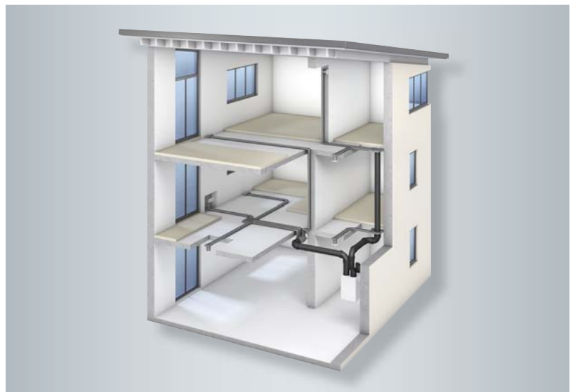
Beispielhafte Verlegung des Luftverteilsystems in der Rohbetondecke
